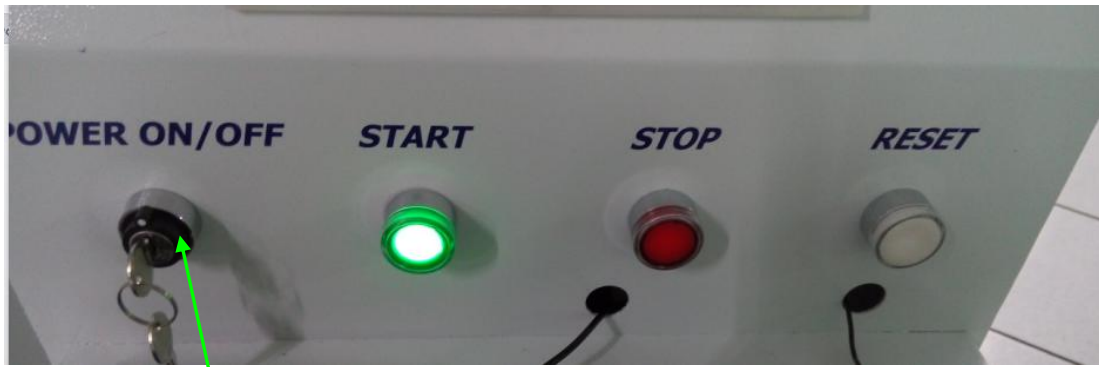
设备钥匙开关，控制电机驱动器以及光源
